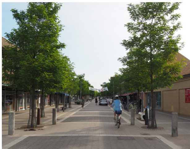
ROBINIETRÆER PLANTET SOM ALLÉ I BEFÆSTELSE MED TRÆHULSRISTE OG BESKYTTELSE AF STAMMER MOD HÆRVÆRK, GÅGADEN M D MADSENSVEJ, LILLERØD
